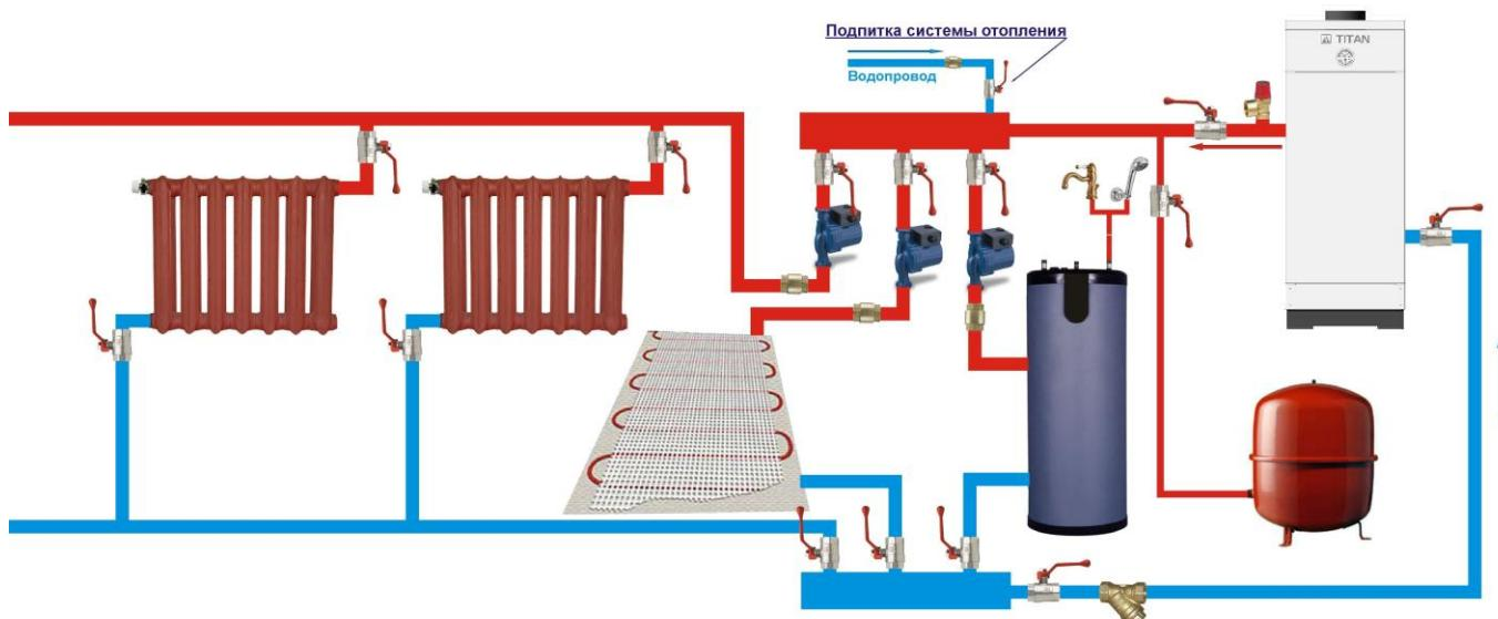
Рисунок 6. Схема подключения котла с общим коллектором
