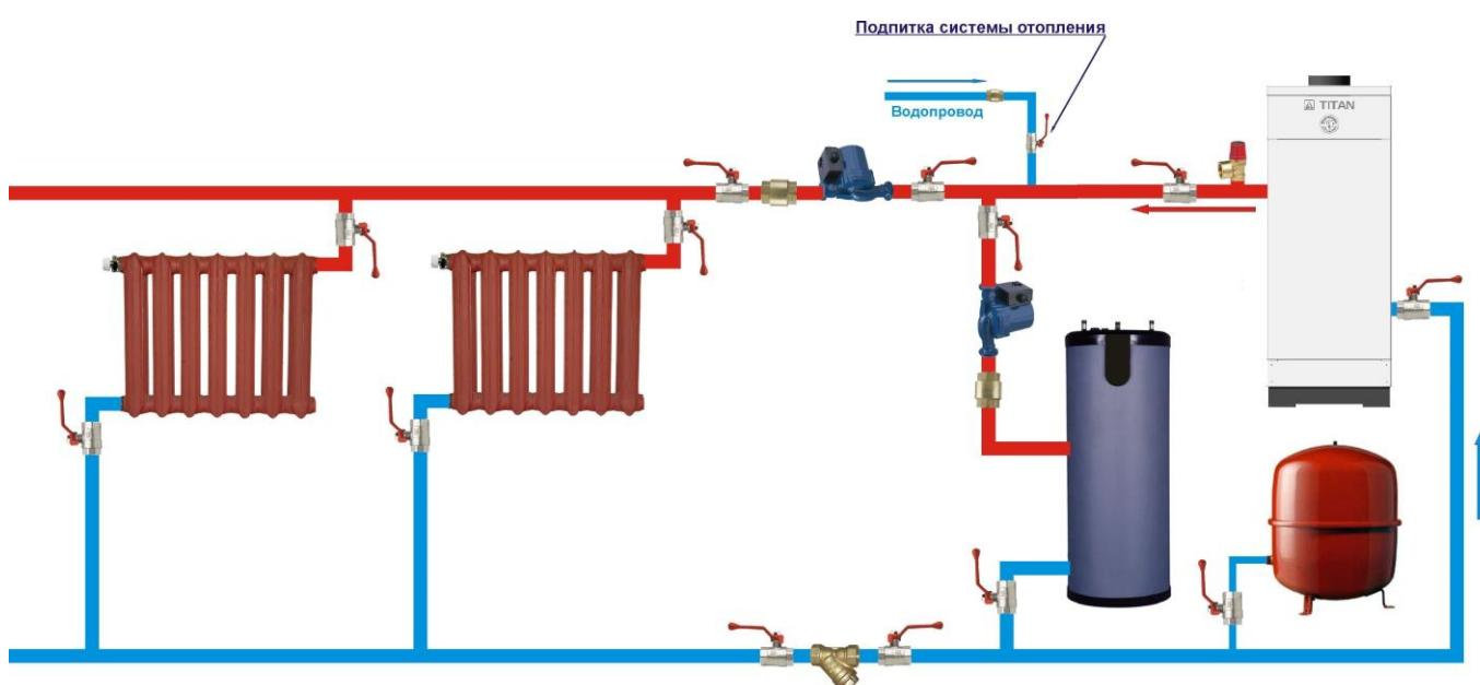
Рисунок 5. Схема подключения котла с принудительной циркуляцией теплоносителя
