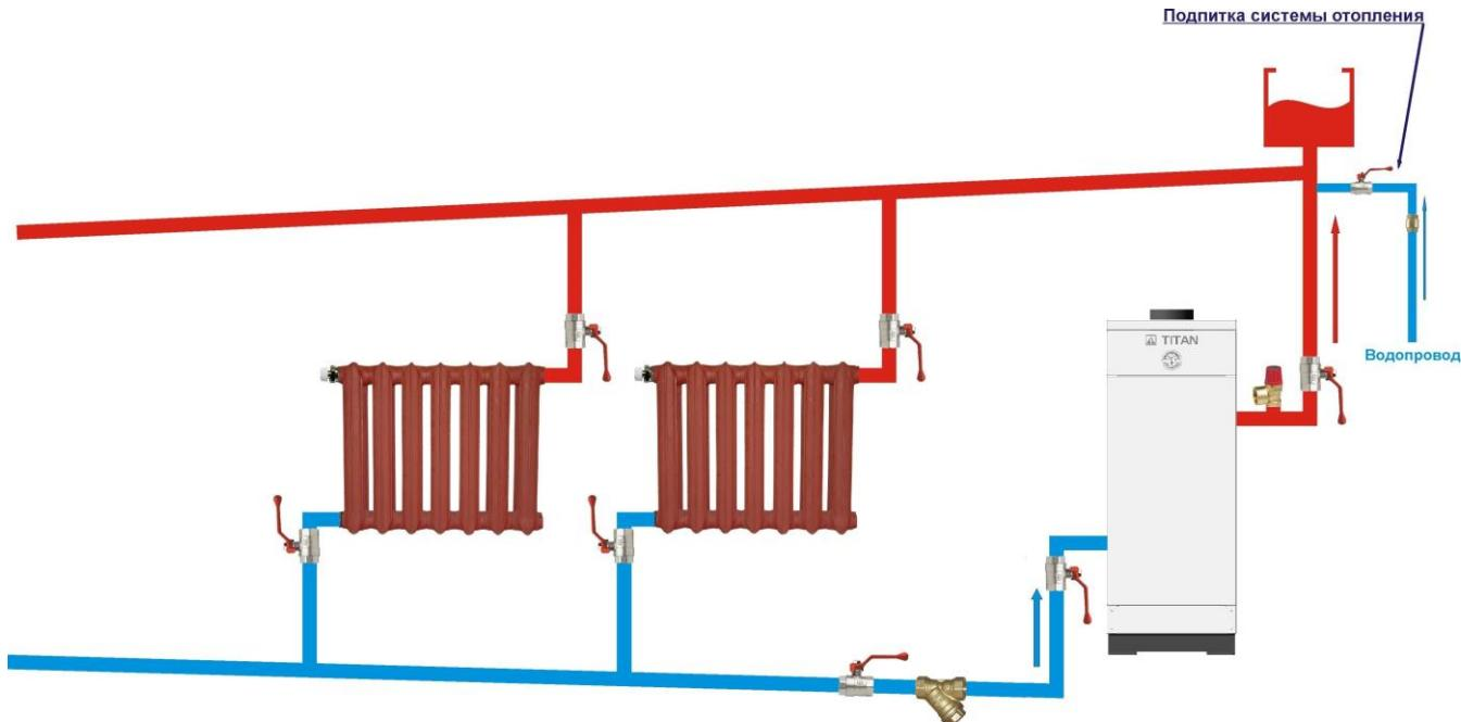
Рисунок 4. Схема подключения котла с естественной циркуляцией теплоносителя
