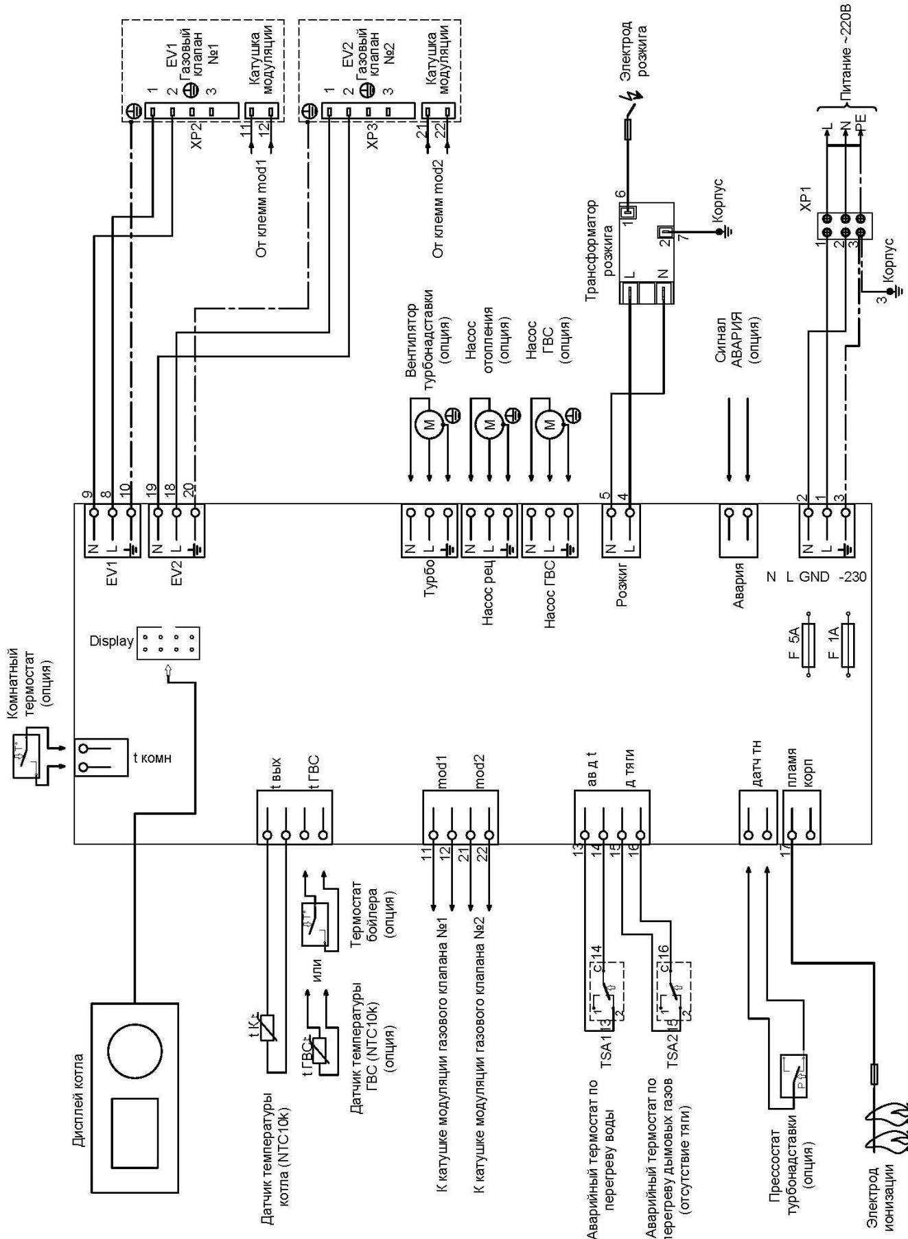
Рисунок 8. Электрическая схема котлов TITAN Z75M; Z85M; Z95M
