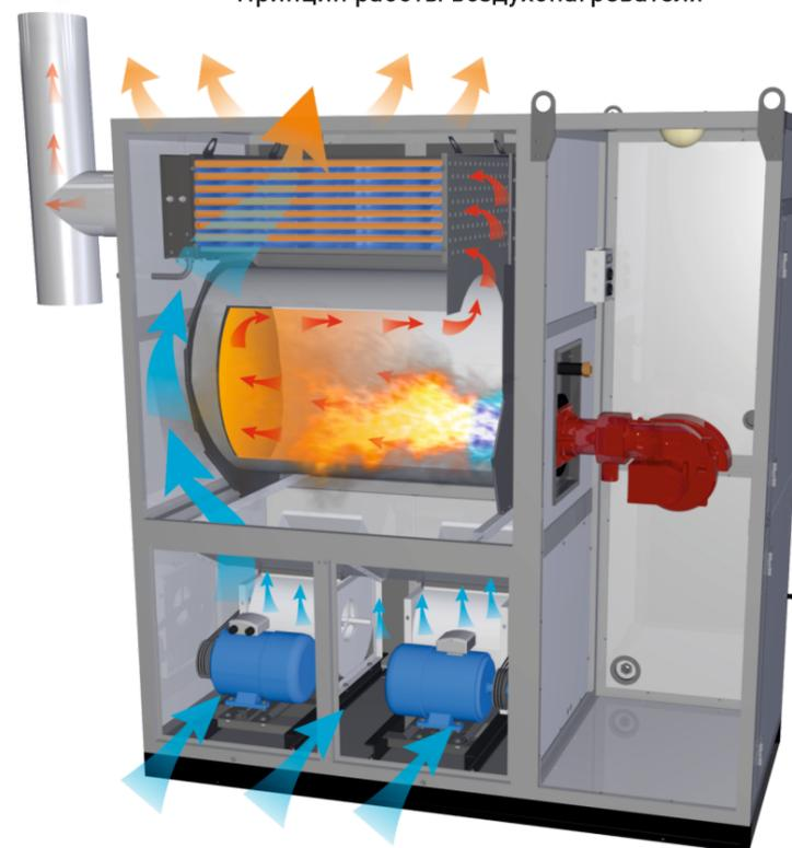
При включении воздухонагревателя наружный воздух всасывается вентиляторами в секцию вентиляции и подается в секцию теплообмена.
